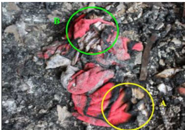
Foto n.7 Foto esemplificativa dell'individuazione del bianco di riferimento: nell'area A si effettuerà il repertamento, poiché nella stessa si sono rilevati valori significativi di V.O.C.; nell'area B si effettuerà il repertamento del bianco di riferimento, in considerazione del fatto che in tale area si rilevano valori poco significativi di V.O.C..
