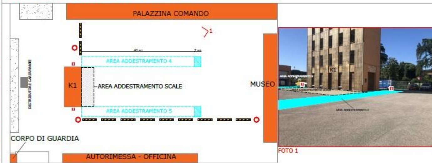
TAVOLA 2 STUDIO E DIMENSIONAMENTO AREE ADDESTRAMENTO PER MODULO DIDATTICO "TUBAZIONI E STENDIMENTI"
